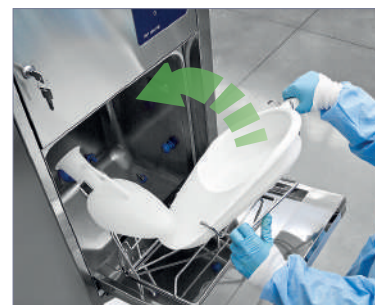
Specjalny obrotowy uchwyt ułatwiający załadunek wyrobów
